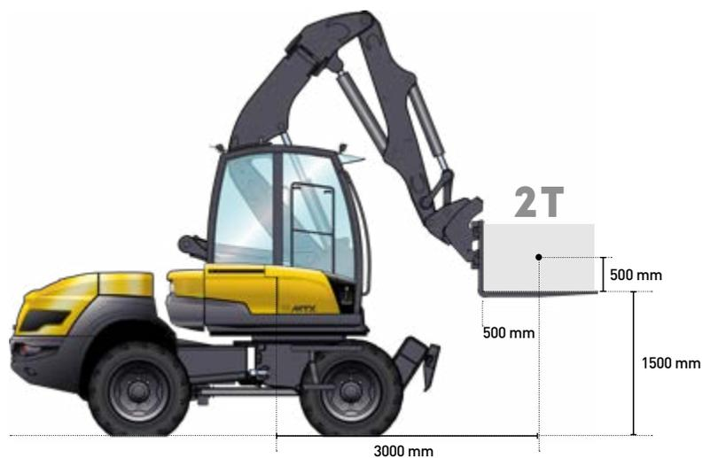
Capacité de levage au lève-palette de 0 à 1,50 m en position optimale des vérins et de l'équipement.
