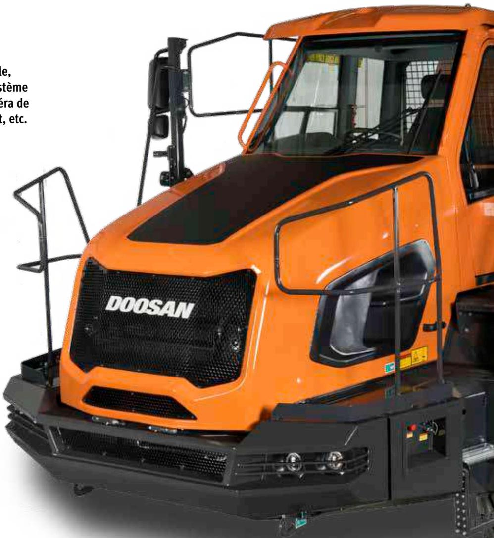
☉ **La sécurité avant tout** : indicateur de pente avec protection contre le déversement excessif de la benne, fonction de maintien du centre de gravité, rambardes tout autour de la cabine, stabilité exceptionnelle et accès dégagé (et toujours propre) à la cabine par l'avant.
